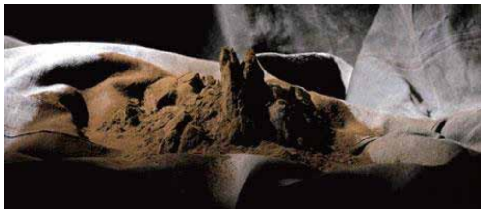
图片所示为使用尼的曼焊烟过滤器两周所过滤出的焊烟微粒。一名焊工每小时产生 20-40 g 烟气，相当于每年约 35-70 kg 左右。
